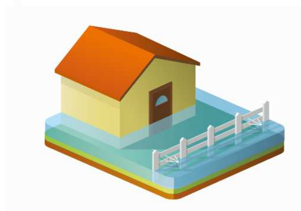
Figure 3: Exemple de clôture assurant la transparence hydraulique. Source : Mayane pour la DDT du Bas-Rhin, 2017
